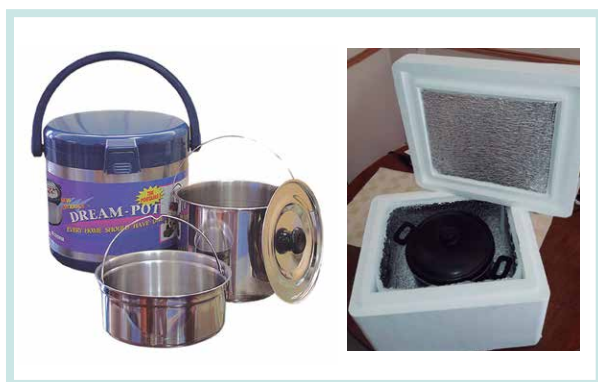
Figura 4. Izquierda: Olla Dream Pot, diseño Australiano Aislante: Aire. Derecha: Olla bruja casera, construida con una caja de poliestireno expandido (EPS) o telgopor de 5 cm de espesor, que se usa para transportar alimentos refrigerados. En el interior tiene una capa de aislación térmica de techos.
